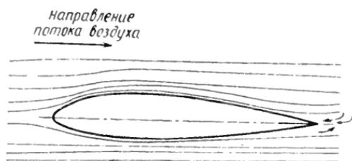
Рис. 2.3. Обтекание профиля крыла воздушным потоком
